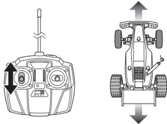
※本体用電池が消耗すると、本体は前後進しますが右左折しにくくなります。すべて新しい電池に交換してください。
