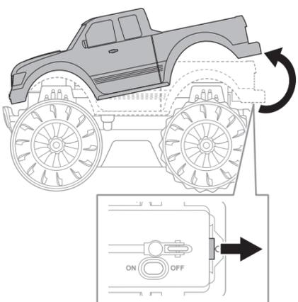
③ 電池カバーのネジをプラスドライバーでゆるめて、電池カバーをはずします。
