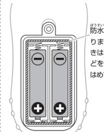
③ 電池カバーを取り付け、プラスドライバーでネジをしっかりとめます。
