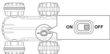
※防水のため電源スイッチにカバーが付いています。実際の電源スイッチのカバーは透けていません。
