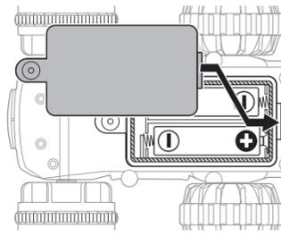
⑥ 電池カバーのネジをプラスドライバーでしっかりしめます。
