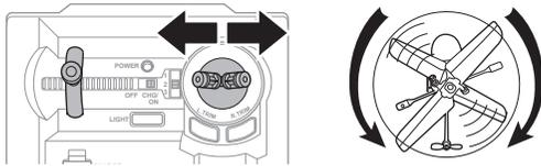
本体を前後進、左右旋回させると電流値が下がり、本体が少し下降気味になります。上昇／下降レバーで高度を調整してください。
