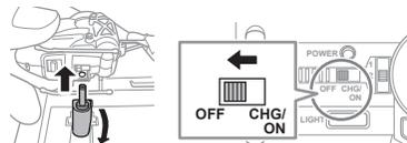
※ コントローラー用電池が消費して本体への充電ができないときは、すべて新しい電池に交換してください。(コントローラーの電池容量が少なくなるとパワーランプ (赤) が点滅します。)
