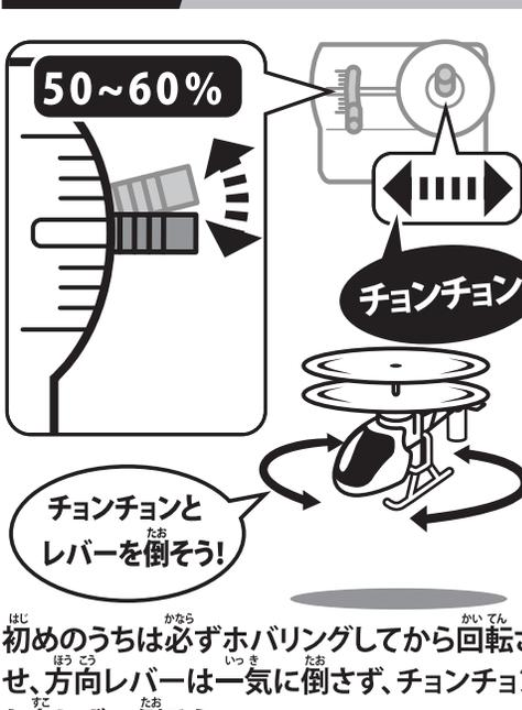
初めのうちは必ずホバリングしてから回転させ、方向レバーは一気に倒さず、チョンチョンと少しずつ倒そう。 ※方向レバーを操作すると高度が下がります。機体を見ながら上昇レバーをゆっくり操作してください。
