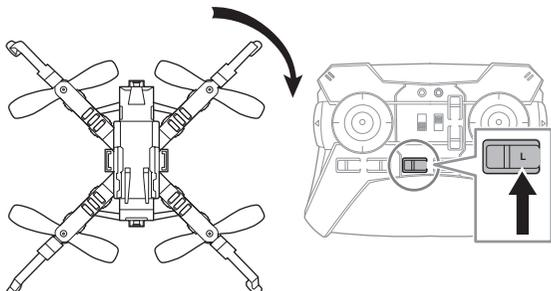
左右回転トリムボタン(YAW)のLを押して調整します。
