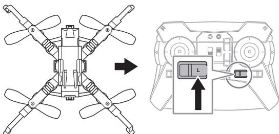
左右スライドトリムボタン (ROLL) の L を押して調整します。
