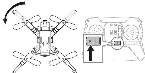
左右回転トリムボタン(YAW)のRを押して調整します。
