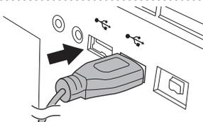
③ 本体の充電ソケットにUSB充電ケーブルの充電プラグを接続します。充電中は本体の充電ランプ（緑）が点灯します。消灯すると充電完了です。
