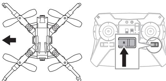
左右スライドトリムボタン (ROLL) の R を押して調整します。
