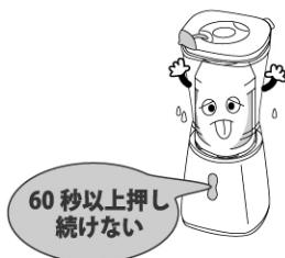
60秒以上、連続して運転すると、内部のモーターが過熱して故障の原因になります。
