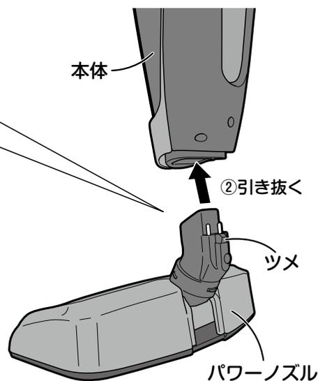
**Point** パワースズルをはずすときは、パワースズル取りはずしボタンを押しながら、パワースズルを引き抜いてください。
