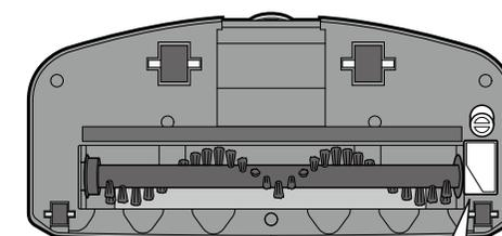
ブラシ押さえ板の取り付けは、ツメをひっかけてから、「カチッ」と音がするまで押し込みます。
