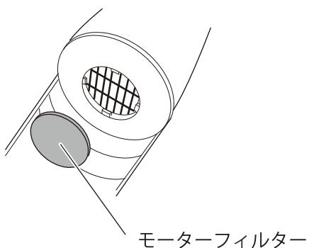
水洗いしたフィルター・モーターフィルターは、完全に乾いてから取り付けてください。湿った状態で取り付けて使用すると故障の原因になります。
