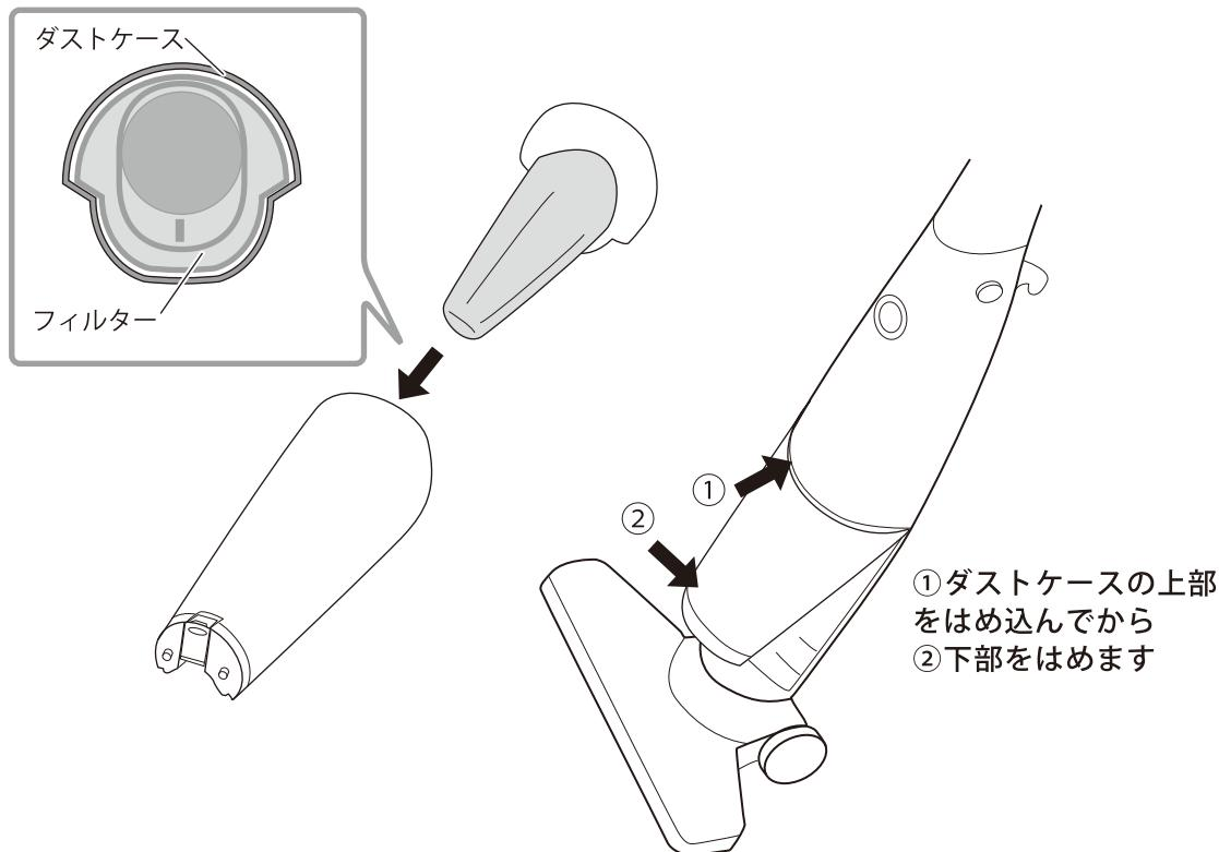
フィルターは必ず取り付けてください。フィルターを取り付けないで使用すると故障の原因になります。
