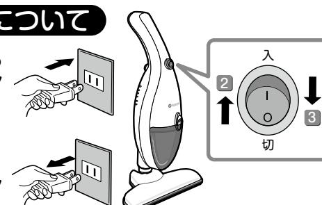
電源スイッチを「|」(入)にしたとき、モーターが回転する反動が手に伝わります。本体を落とさないようにしっかりと持ちながら電源スイッチを操作してください。
