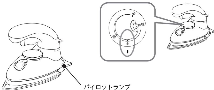
パイロットランプが点灯して、かけ面の温度が上昇します。設定温度になるとパイロットランプが消灯して、アイロンがけの準備が整ったことをお知らせします。
