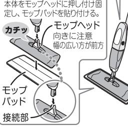
本体をモップヘッドに押し付け固定し、モップパッドを貼り付ける。
