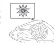
ペアリングに失敗したときは、本体とコントローラーの電源スイッチをOFFにして再度手順①からやり直してください。
