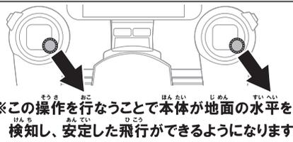
※この操作を行うことで本体が地面の水平を検知し、安定した飛行ができるようになります。
