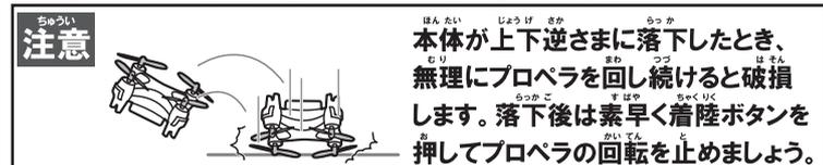
本体が上下逆さまに落下したとき、無理にプロペラを回し続けると破損します。落下後は素早く着陸ボタンを押してプロペラの回転を止めましょう。
