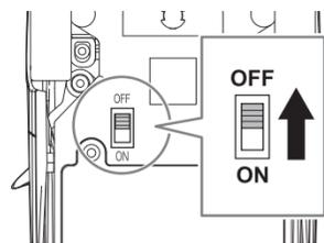
② コントローラーの電源スイッチを OFF にします。パワーランプ（赤）が消えていることを確認して、電池をはずします。
