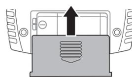
※コントローラー用電池が消耗すると、パワーランプ (赤) が消灯して本体を操作できなくなります。新しい電池に交換してください。
