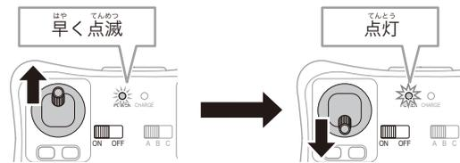
※ コントローラーの上昇／下降レバーを下に倒していない状態で電源スイッチをONにすると、パワーランプ（POWER／赤）が点滅してペアリングできません。上昇／下降レバーを下に倒してペアリングしてください。
