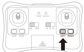
本体の回転がおさまるまで、コントローラーのトリム調整ボタン (LEFT) をくりかえし押し調整します。
