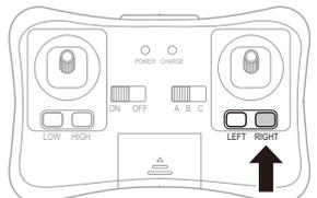
本体の回転がおさまるまで、コントローラーのトリム調整ボタン (RIGHT) をくりかえし押し調整します。
