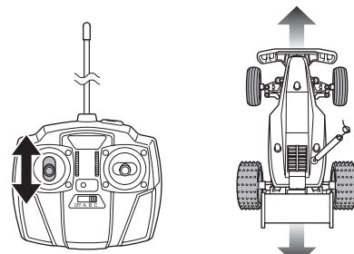
※本体用電池が消耗すると、本体は前後進しますが右左折しにくくなります。すべて新しい電池に交換してください。
