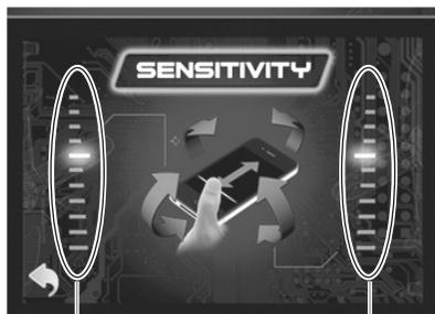
前後進操作角感度調整目盛り      左右回転操作角感度調整目盛り
