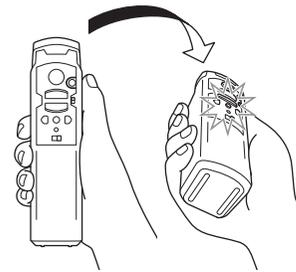
左旋回または右旋回中、本体のホバリングライト（青）は消灯します。動作が安定すると点灯します。コントローラーを傾けている間、コントローラーのパワーランプは青色で点滅します。コントローラーを傾ける角度が大きいくほど、左旋回または右旋回の旋回速度が速くなります。
