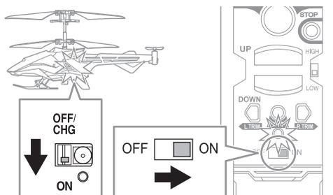
③ 本体を平らな場所に置き、コントローラーを水平に持って離陸 & ホバリング / 着陸ボタンを1回押しします。
