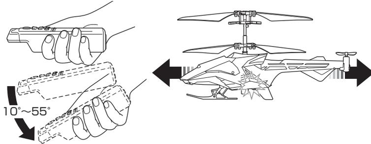
前進または後進中、本体のホバリングライト（青）は消灯します。動作が安定すると点灯します。コントローラーを傾ける角度が大きいくほど、前進または後進の速度が速くなります。
