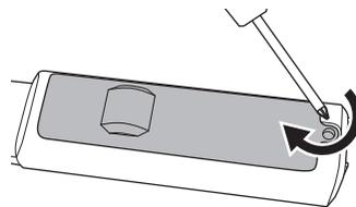
※ コントローラーの電池容量が少なくなるとパワーランプ（赤）が点滅します。すべて新しい電池に交換してください。
