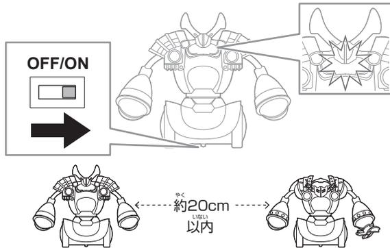
※ 本体の電源スイッチをONにする前に、コントローラーのLEDが消灯していることを確認してください。
