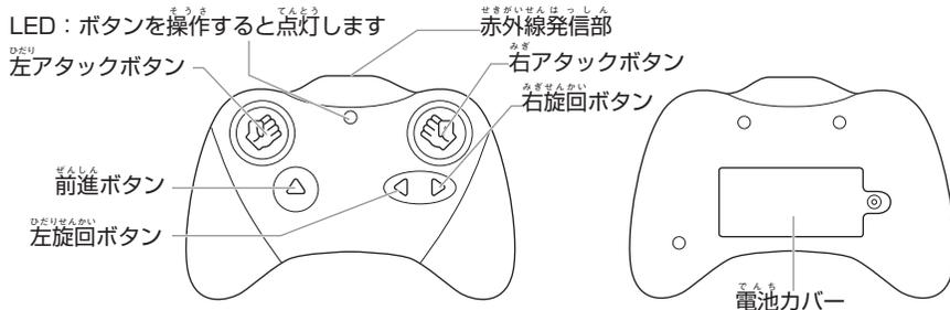
※コントローラーに電源スイッチはありません。前進ボタン、左右旋回ボタン、左右アタックボタンのいずれかを押すと電気が流れ、LEDが赤く点灯します。約30秒間コントローラーを操作しないと、自動で電源がOFFになりLEDが消灯します。
