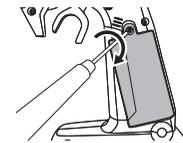
\* コントローラーの電池容量が少なくなるとパワーランプ (赤) が暗くなります。すべて新しい電池に交換してください。
