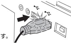
④パソコンから専用充電USBケーブルを外し、専用充電式電池と専用充電USBケーブルのコネクタを持って真っすぐ抜きます。パソコンの電源スイッチをOFFにします。
