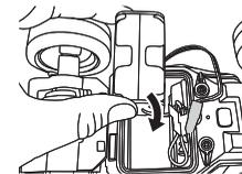
⑦ 電池カバーを取り付けて、電池カバーロックを矢印方向に回し、電池カバーをロックします。
