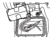
⑥ 単3形電池用ケース、電源ボックスのイラストの位置にセットします。
