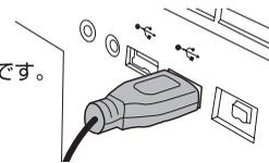
②パソコンの電源スイッチをONにして、専用USB充電ケーブルを接続します。専用充電USBケーブルの充電ランプ(赤)が点灯します。
