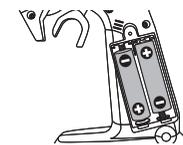
④ 電池カバーを取り付け、プラスドライバーでネジをしめます。
