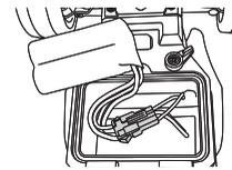
⑤ 電池カバーを取り付けて、電池カバーロックを矢印方向に回し、電池カバーをロックします。
