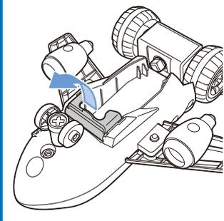
② 電動ユニットを機体本体にセットします。機体側の突起の角度を電動ユニットの穴の角度と同じになるように機体側の突起を回して調整します。
