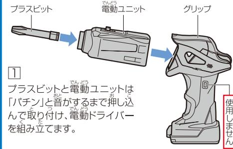
① プラスビットと電動ユニットは「パチン」と音がするまで押し込んで取り付け、電動ドライバーを組み立てます。
